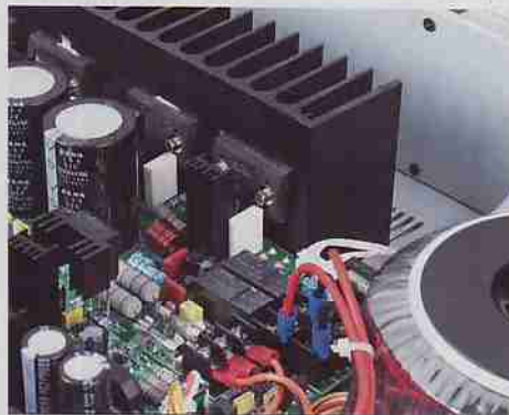
Die Sanken-Transistoren machen ordentlich Dampf, der über Kühlkörper abgefangen wird
