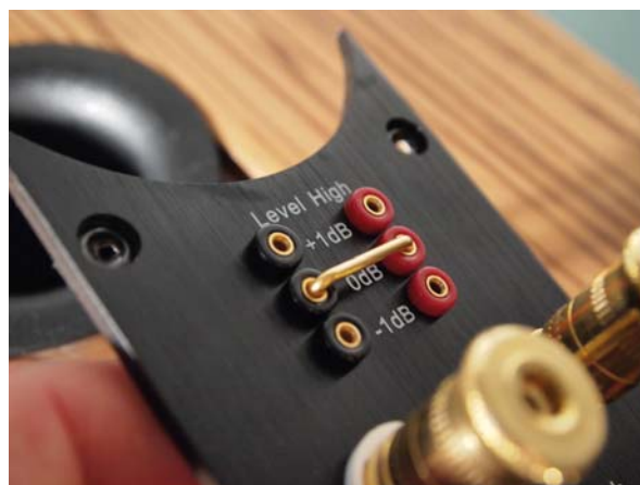
Das abmontierte Terminal mit der Steckbrücke zur Hochtönenanpassung
