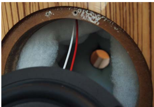
In die Röhre geschaut: Die Phonar Credo Primus Primus sind Bassreflexboxen – vorne der vom Gehäuse gelöste Bass-Mittel-Treiber
